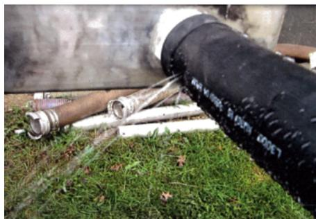
Anomalie dans la perforation des trous des diffuseurs d'air
